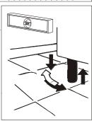
**Attention:** Si l'appareil n'est pas mis à niveau correctement, son fonctionnement peut être pertubé et l'évacuation de la condensation empêchée.
