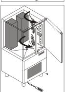
Il faut laver simplement avec de l'eau tiéde le joint de la porte et l'essuyer soigneusement en le frottant avec un chiffon sec. Pendant les opérations de nettoyage il faut se protéger avec des gants.
