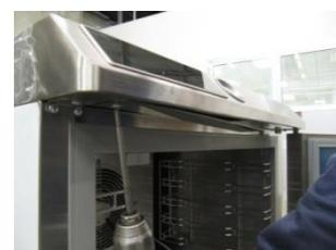
Desatornille los tornillos y retire la tapa para acceder a la tarjeta de vídeo y a la encoder
