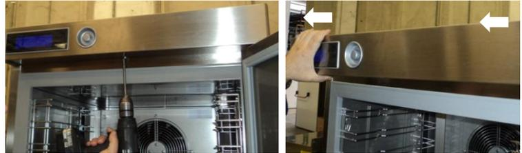
Desatornille los tornillos y retire la protección para acceder a la tarjeta de vídeo y a la encoder
