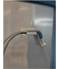
Pour assurer un fonctionnement optimal de la sonde à cœur, il est recommandé de la nettoyer périodiquement. La sonde doit être nettoyée manuellement à l'eau tiède et au savon neutre, puis rincée à l'eau claire et avec une solution désinfectante.
