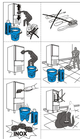
**Attention:** Pour le nettoyage de l'ACIER INOX n'utilisez jamais de pailles de fer et ne les laissez pas posées sur les surfaces de l'appareil car de légers dépôts ferreux pourraient rester sur les surfaces et provoquer des formations de rouille et compromettre l'hygiène.
