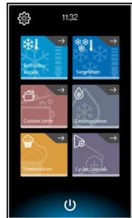
En sélectionnant « arrêter le levage », la machine propose un cycle d'abattement, de conservation, de réveil, de levage et un cycle lent successif. Avant de démarrer, la machine demande de régler la date et l'heure de la fin du cycle.
