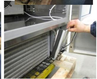
Retirer les vis de blocage du tableau électrique.
