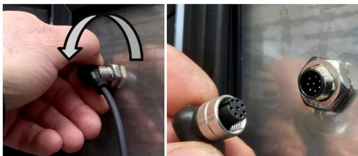
Remplacer la sonde au cœur en revissant complètement le connecteur.
