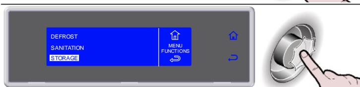
7. Seccione o tipo de conservação girando o manípulo
