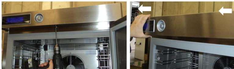
Desaperte os parafusos e retire a tampa de acesso a placa de vídeo e do encoder.
