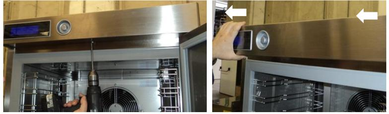
Lösen Sie die Schrauben und entfernen Sie die Abdeckung, um die Grafikkarte und den Encoder zugreifen.
