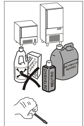
Richten Sie keinen direkten Wasserstrahl auf das Gerät zur Reinigung, vor allem nicht mit einem Wasserhochdruckstrahlgerät.
