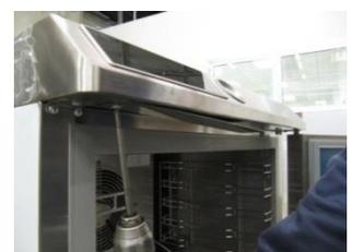
Lösen Sie die Schrauben und entfernen Sie die Abdeckung, um die Grafikkarte und den Encoder zugreifen.
