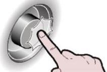
5. Drehgriff drücken, um Abschnitt ALARM RESET zu öffnen
