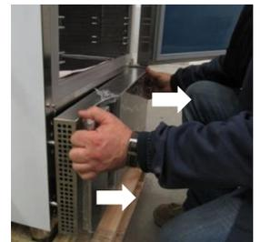
Schrauben des Verschlusspaneels entfernen.
