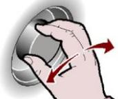
4. Drehgriff drücken, um Abschnitt AUTOMATISCH zu öffnen
