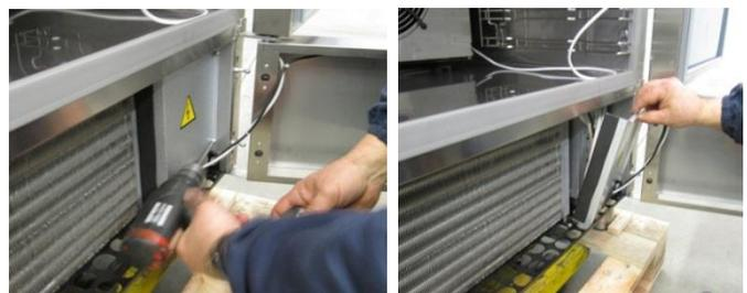
Verriegelungsschrauben des Schaltkastens entfernen.
