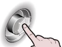
9. Datum durch Drehen des Drehgriffs eingeben, zur Bestätigung des Werts und weiter zum nächsten Wert Drehgriff drücken oder mit AUSFÜHREN fortfahren
