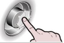
7. Je nach Gerät Anzahl der Stufen Griff drehen auswählen
