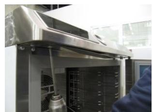
Desaperte os parafusos e retire a tampa de acesso a placa de vídeo e do encoder.
