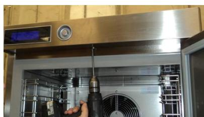
Desaperte os parafusos e retire a tampa de acesso a placa de vídeo e do encoder.
