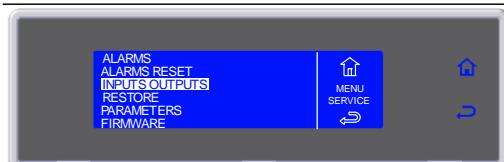
6. Pressione o manípulo para visualizar a lista INPUTS OUTPUTS
