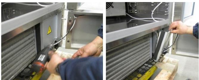
Remover o parafuso de bloqueio do quadro eléctrico.
